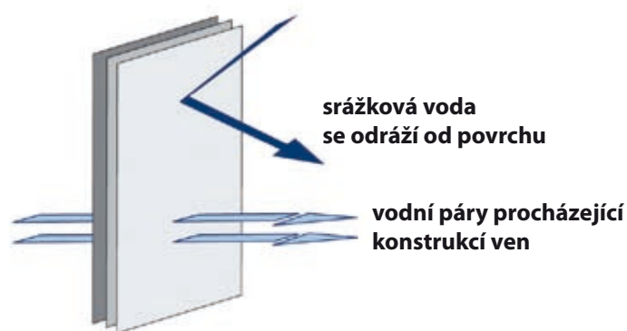
Princip sanačního omítkového systému
