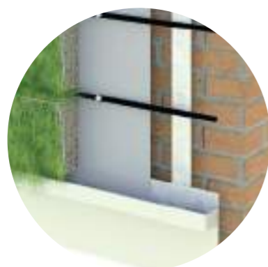
FASÁDA PŘÍMO KOTVENÁ do nosné obvodové zdi
