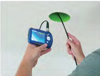
Kontrola čistoty koncových tvarovek a potrubí.
