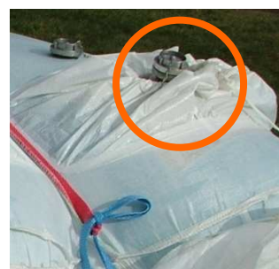
Plnicí ventil opatřený pevnou hadicovou spojkou C52
