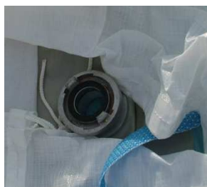
Plnicí ventil opatřený pevnou hadicovou spojkou C52
