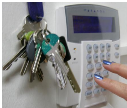
Elektrická zabezpečovací signalizace EZS
