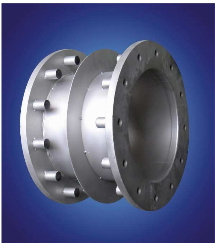
01 Chráničky pro zabetonování a spojení s izolační folií pomocí volné příruby
