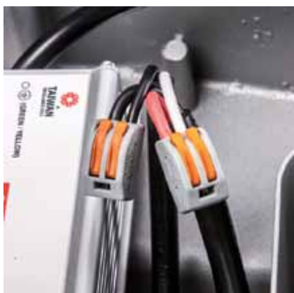
Použití německých konektorů WAGO pro připojení výstupu je bezpečné, pohodlné a rychlé
