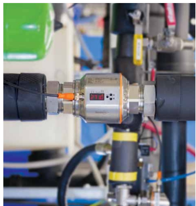
Magneticko-induktivní senzor proudění pro měření množství vody ve filtračním systému.
