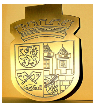
Tvarový výpalek, lept do mosaz tl. 4 mm, barvení dle RAL, rozměr 640 x 460 mm
