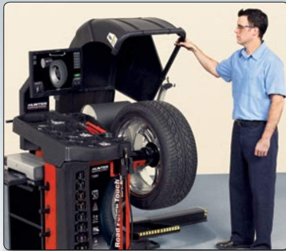
Road Force Touch® měření sil a vyvážení začíná sklopením krytu kola.
