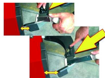
Zesílená pístnice a nastavitelný chod odrážecího nástroje
