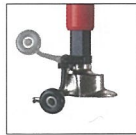
Mechanické rolny stlačující bočnici pneumatiky
