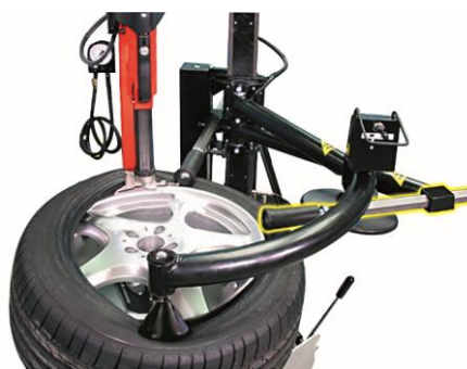
Pneumatické pomocné rameno a stlačovač PLUS83N+G800A112
