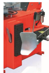
Dvojčinná odrážecí lopata zabraňuje poškození patek nebo ráfků
