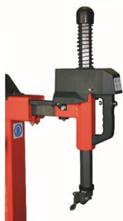
Aretace montážní hlavy s automatickým nastavením vzdálenosti od ráfku
