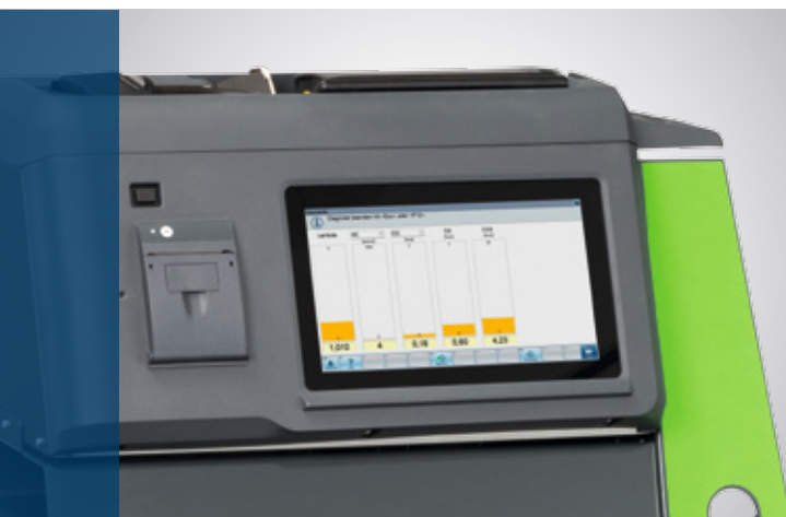
10“ kapazitiver Touchscreen Monitor und Platz für das Rauchgastrübungs-Messmodul BEA 070
